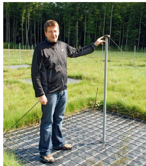
Dr. Matthias Hoeft, Projektleiter LOFAR an der Thüringer Landessternwarte Tautenburg, an einer Einzelantenne für den Frequenzbereich 10–80 MHz (Low Band). An der Spitze des Halterohres befindet sich ein rauscharmer Vorverstärker. Die vier gegen Erde isolierten Spanndrähte bilden einen Kreuzdipol. Das Drahtgitter wirkt als Reflektor.
