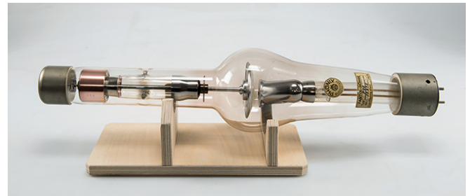
Drehanodenröhre Pantix P40, VEB Phönix Röntgenröhrenwerk Rudolstadt (Sammlung Elektromuseum), Foto: G. Roleder
